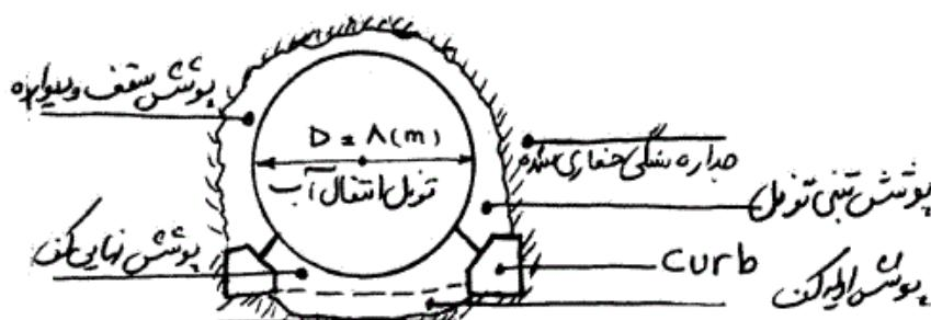
۱) به ترتیب ابتدا اجرای curb - اجرای پوشش سقف و دیواره - اجرای پوشش اولیه کف - اجرای پوشش نهایی کف
